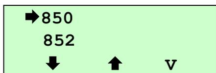
使用此選項可設定印表機的 code page (字元集)。更詳盡的資料請參閱指令集手冊。當進入此選項，此 ➡ 圖示所指的即為目前設定的字元集。按 ↓ 和 ↑ 下方的 Ⓐ 鍵，可往上或往下捲動選取視窗選項，在 ➡ 圖示所指的 code page 按 “V” 圖示下方的 Ⓐ 鍵即完成設定。
